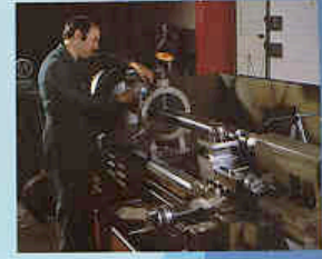
Fan shaft machining.
